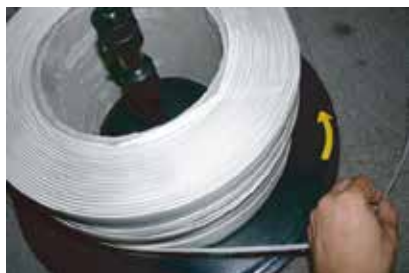
④矢印のシールにの方向を確認しながら、バンドを置きます。
