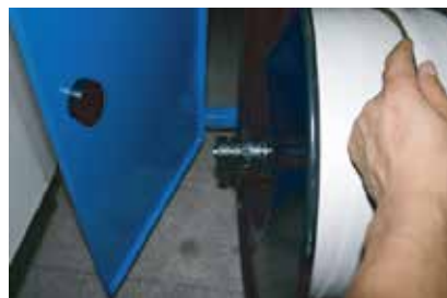
⑤はずしたふたをかぶせ、プラスチックの留め金をつけます。留め金が左側に来ていることを確認しながら、元の位置に戻します。
