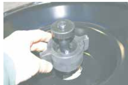
③プラスチックの留め金が付いている方を上に向け、時計まわりに回して外します。(逆ネジ)
