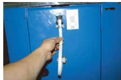
⑨ふたを閉めて、外にバンドを出します。そのまま上の差込口に差し込みます。
