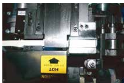
⑪内部のシーラー部分から、バンドが出てきたらOKです。
