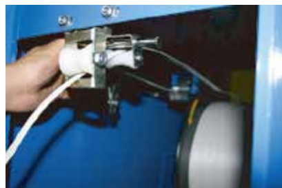
⑧次に、手前側のローラーの下を通します。このとき上下を間違えないように気をつけます。
