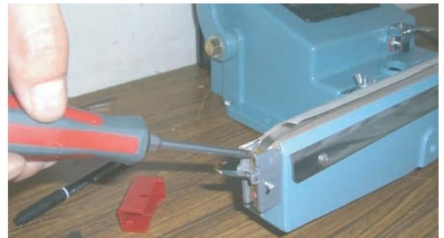
⑥両側のつめを立てたまま、もう片方の金具のネジを締め、固定します。
