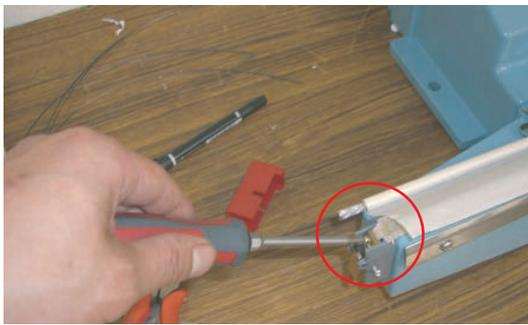
②赤いカバーを外し、ヒーター線が止まっているネジ(片側2個)を緩めます。(＃1のドライバーを使ってください。)
