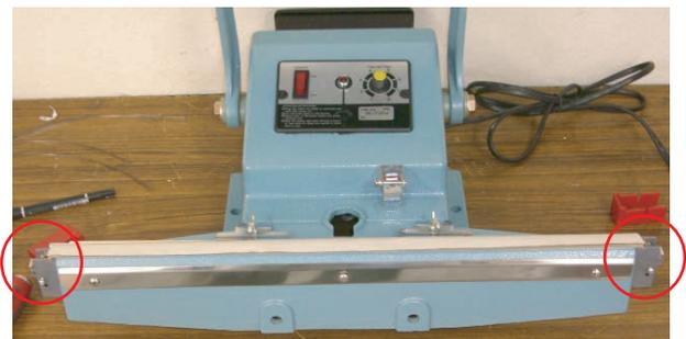
⑦つめを元に戻すと、ヒーター線がピンと張り、①で外した赤いカバーを付けて、完了です。
