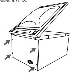
更に上蓋のネジ4個、蓋を押さえるフックを外すと、チャーンバー部分が外れるので作業しやすくなります。
