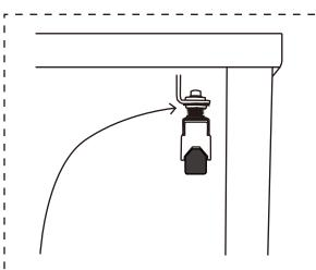
スイッチを機械にセットするときは、蓋が完全 に閉じる少し前に、スイッチがオンになる(カーチッという)ところに六角ナットを調整して取り付けてください。
