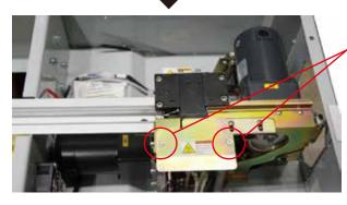
・⊕ネジを2か所外す。 WARNING と書かれた プレートを外す。 すると、ヒータープレートが見えてきます。
